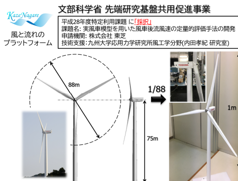
図3 風洞実験用ラボスケール風車模型の開発実績
