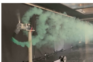
図2 浮体式風車ウエイク現象の可視化
