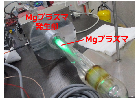
図2. マイクロ波プラズマ発光の様子
