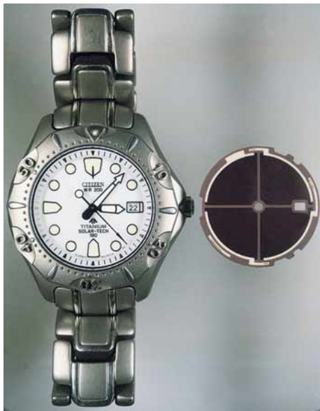
7-14：腕時計用太陽電池 ポリエステルフィルム / 下部金属電極層 / アモルファスシリコン積層膜 / 上部透明電極層で構成されるフレキシブル太陽電池。200ルクス下で1.5V、12.6 \mu Aの出力、外径28mm、厚さ0.23mm以下で、腕時計に組み込まれている。（提
