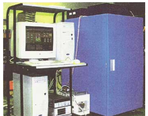
1.6-16：電力負荷平準化用電力貯蔵システム
