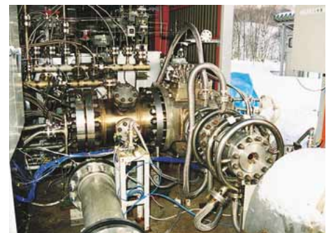
1.2-31：実温高圧試験設備 燃焼器及びタービン翼（遮熱コーティング）の性能及び耐熱性等を確認するため、高温高圧条件を作り出す試験装置を秋田県田代町に製作しました。
