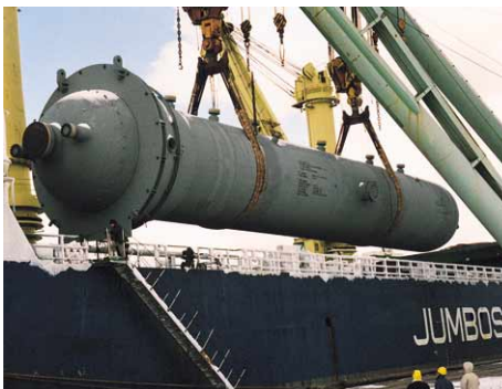
7-11：水素化精製用反応塔 オランダの製油所向けに船積みされる反応塔。1基の重さが1,450トンでシェル母材の厚さが273mmで、3Cr-1Mo-.25V-Ti-B鋼（ASME Code SA336-F3V相当材）で製造された。（提供：(株)日本製鋼所）
