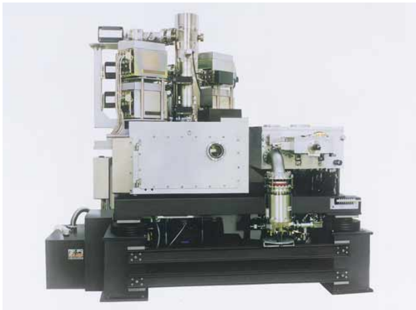
7-16：電子ビームマスク描画装置 4G DRAMレベル（最小線幅0.15 \mu m）をターゲットとして、5インチから9インチまでのマスクに、パターン位置精度20nm、寸法精度18nmの多重描画を行う装置。（提供：東芝機
