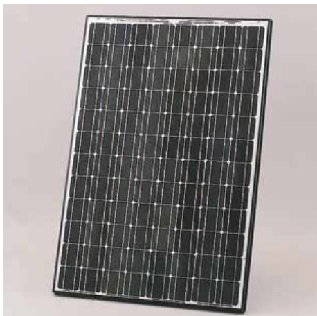
7-15：ハイブリッド型太陽電池 単結晶基板上に約200 \mu mで薄膜アモルファスシリコンを積層した太陽電池モジュール。セル変換効率17.3%、モジュール出力180W（50.7V \times 3.55A）（提供：三洋電機株）
