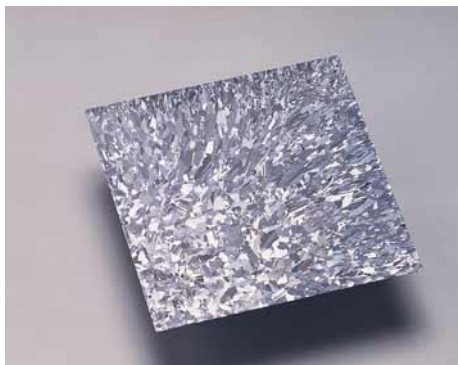
7-18：太陽電池用多結晶シリコン基板 150mm角 \times 350 \mu m厚のシリコン基板上に形成された多結晶シリ
