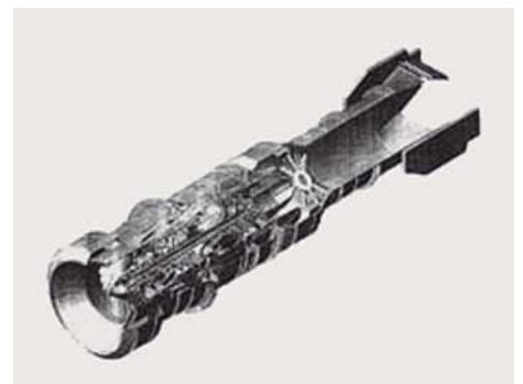
マッハ5の超音速輸送機用推進システム(産業技術開発部門発足時の大型プロジェクト)
