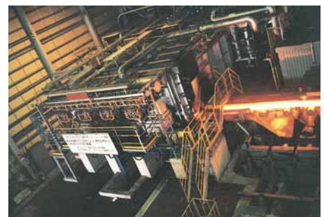
1.7-27 : 高性能工業炉を導入した連続式加熱炉
