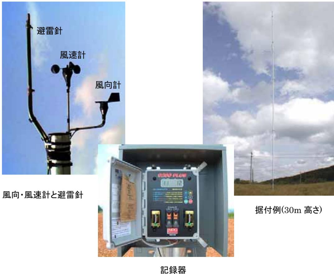
図4.2.2-1 観測装置と据付例の写真
