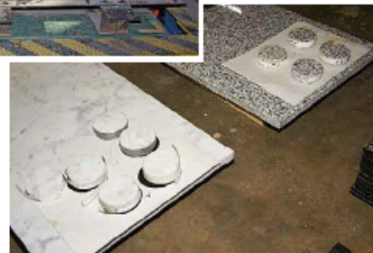
(左) 試験体の様子。試験体は何度も加振した後だったため、完全に免震効果を発揮するだけの荷重をかけることができなかった (下) 2種類の石材についても研究が進む
