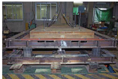
(左) 試験体の様子。試験体は何度も加振した後だったため、完全に免震効果を発揮するだけの荷重をかけることができなかった (下) 2種類の石材についても研究が進む
