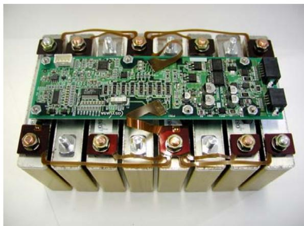
図 3-13 平成 20 年度開発電池監視回路基板
