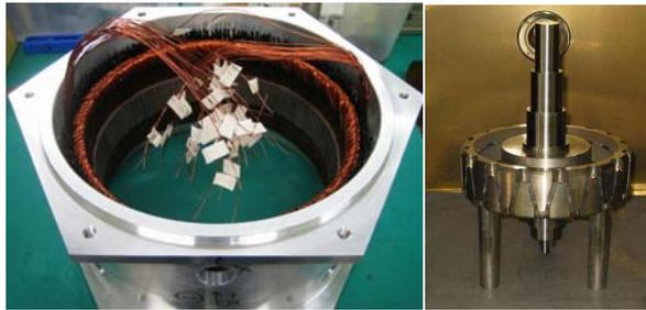
図 3-46 試作機概観図 固定子(左)と回転子(右)
