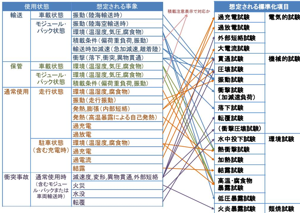
図 3-95 安全性評価試験標準化項目の調査
