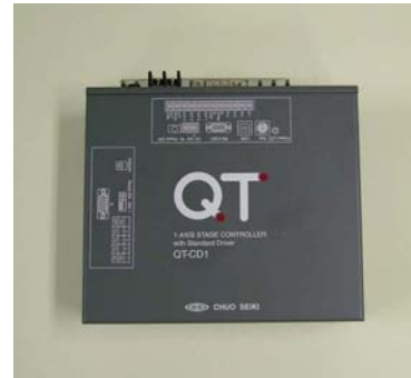
自動ステージ用1軸コントロールドライバ(中央精機社QT-CD1)
