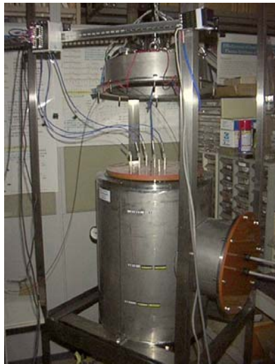
図 A-(2)-18 高周波加熱式吸着回収試作機
