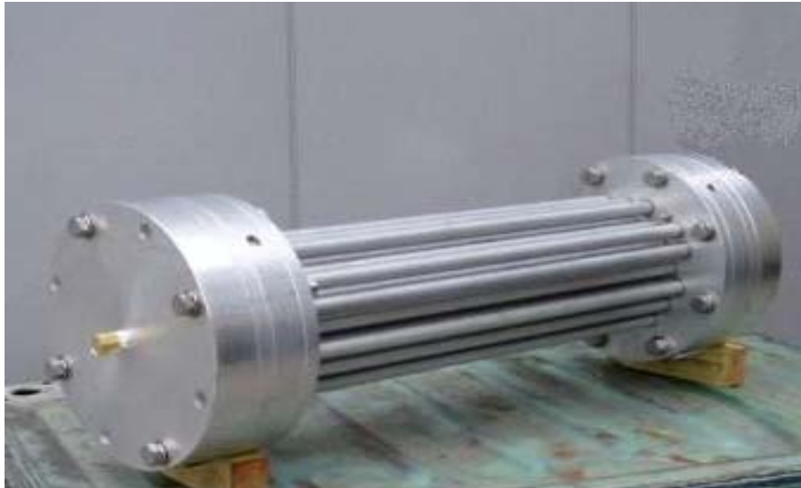
図 A-(6)-11 単管エレメント 33 本からなる ゼオライト膜実機モジュール
