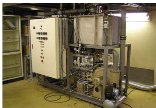
図 A-(2)-2 通電加熱式試作機
