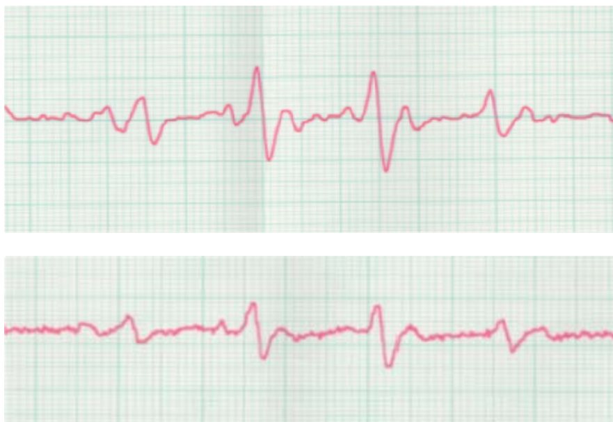
図 A-(4)-5 (上) 蒸留水 3 L に 10 分間、酸素マイクロバブル (低濃度型) を流通・圧壊させて生成するラジカル、(下) 10 秒間オゾンマイクロバブル流通圧壊の場合、(1:2:2:1 のピーク OH に帰属できる)
