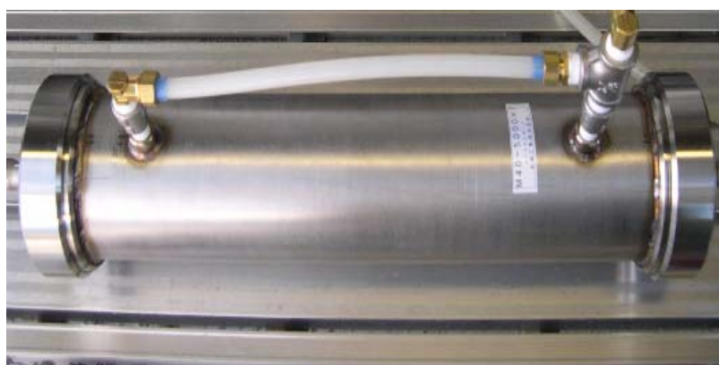
図 A-(6)-16 VOC 透過膜モジュール (実規模サイズ)
