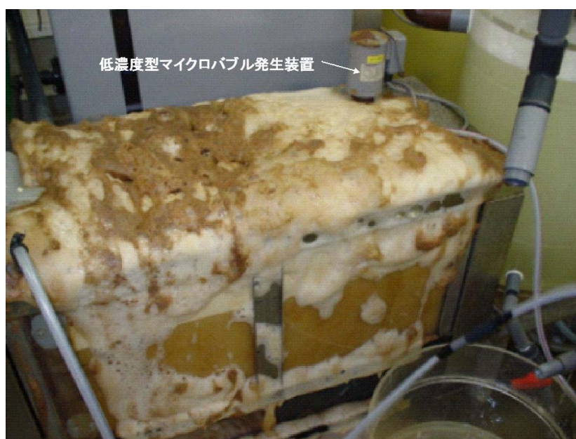
図A-(4)-9 低濃度型による排水処理（異常な発泡）
