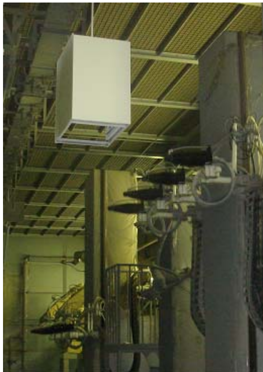
図 B-(2)-12 ワゴンワークを塗装するレシプロケーターと静電スプレーガン
