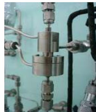
中心衝突型高圧マイクロミキサ(産総研開発品)
