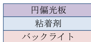
図 2.5.2.2.3-2 バックライト高度集積部材の層構成図
