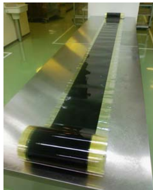
写真 2.5.1.1.3-2 偏光／位相差フィルム一体化部材（塗布方式）ロールの外観
