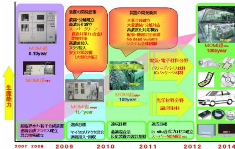
図 1. 1. 3. 1-1 超臨界水ナノ粒子合成装置のロードマップ
