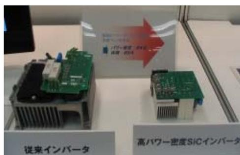
図 1. 3. 1 - 1 小型化された SiC インバーターの一例
