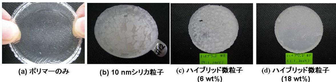
図4.2.3.1-6 合成したハイブリッド微粒子により作成した硬化物の外観（充填物なしの場合、10nmシリカ粒子を用いた場合との比較）
