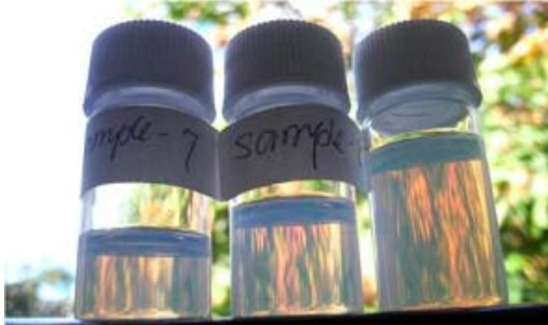
図 2.5.2-8 表面修飾チタニアのトルエン分散液
