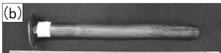
図③-30 直径 22 mm の押出成形体
