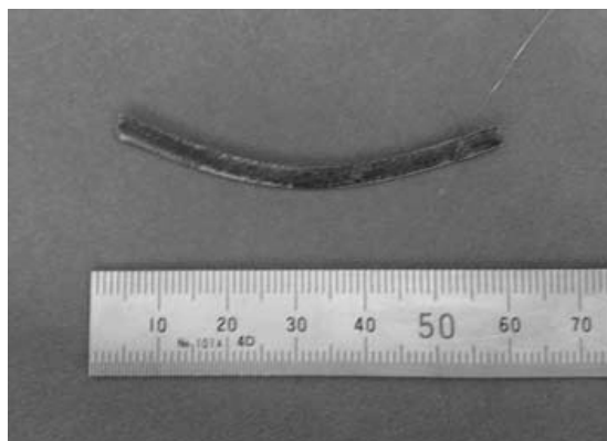
図③-50 Pd 基金属ガラス箔 + 純 Cu 箔で作製したクラッド材
