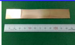
冷間圧延材外観
