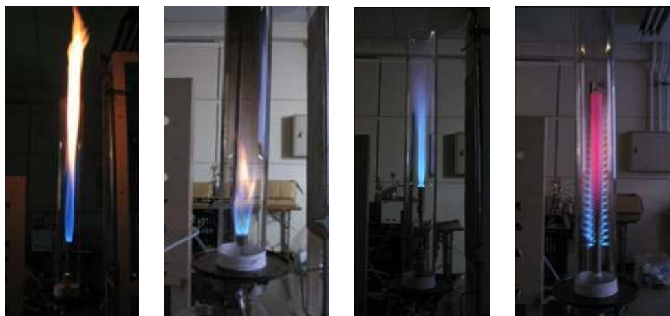
円管型バーナー パイロットバーナー ポイントバーナー パイプバーナー
