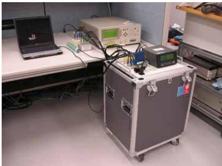
図 2.3-10 キャパシタンス・交流抵抗遠隔校正システムの外観
