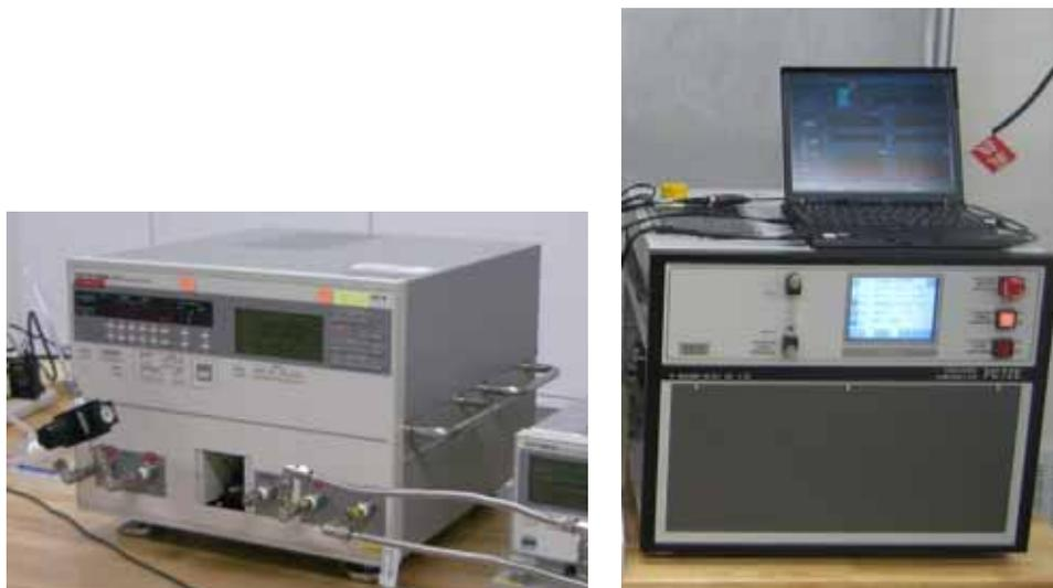
図 2.7-7 開発した H18 統合型仲介器。（左）気体差圧用、（右）液体圧力用
