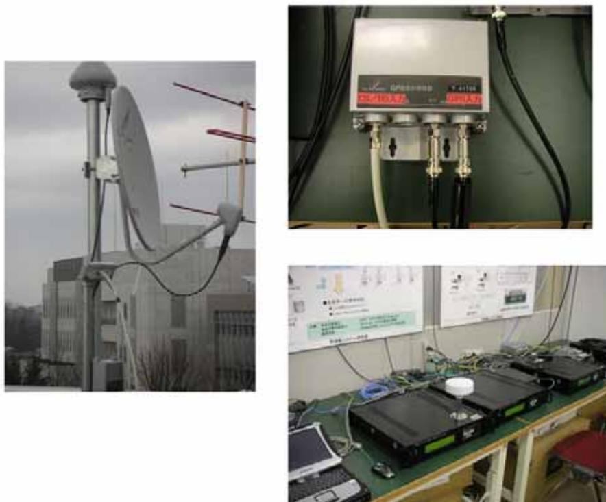
図 2.1-8 開発した屋外機器、周波数変換部、並びに屋内実験室内で複数の GPS 受信機器で再放射信号を受信している光景
