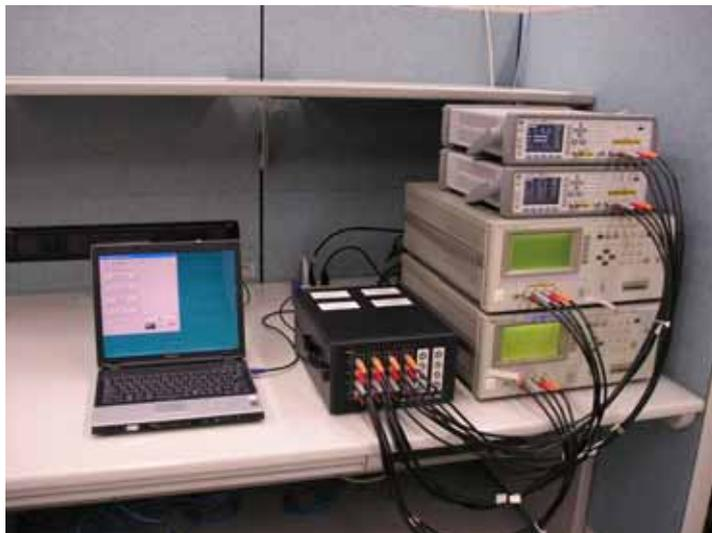
図 2.3-13 LCR メータ遠隔校正システム（コンパクト型）の外観
