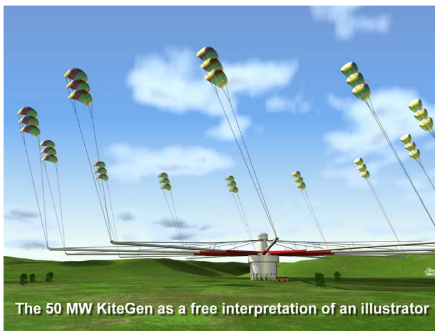
図1 カイトジェン(KiteGen / Kite Wind Generator)のイメージ図
