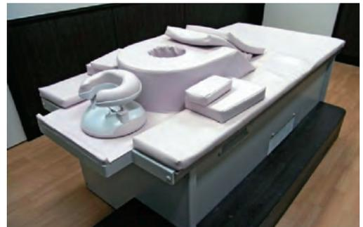
図9：座位型(左)と伏臥位型(右)の乳がん診断用PET試作機
