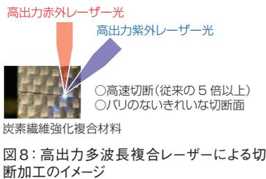
図8：高出力多波長複合レーザーによる切断加工のイメージ
