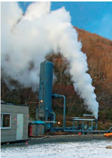
図29:北海道奥尻西部地域での地熱開発促進調査の噴出試験の様子
