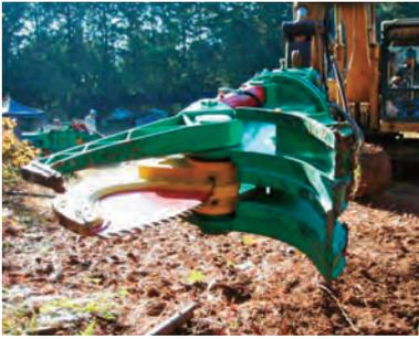
図3：木材チップ化用の切断機「2008年度採択 新エネルギーベンチャー技術革新事業（ウエダ産業株式会社）」
