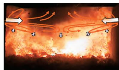
高温空気燃焼制御技術を用いた燃焼
