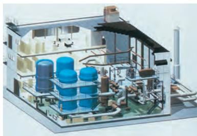
図3：溶融炭酸塩形燃料電池（1000kW級パイロットプラント鳥瞰図）
