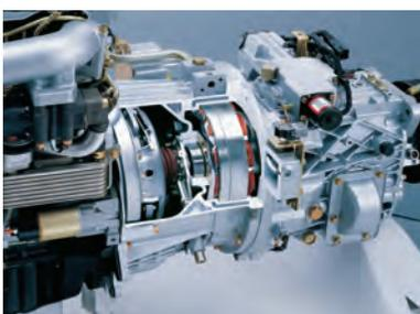
図4：機械式自動変速機INOMAT-II(右側)とモータ内部(中央)
