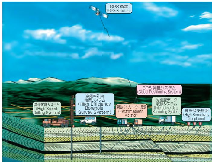
図4：高精度高分解能反射法地震探査システム
