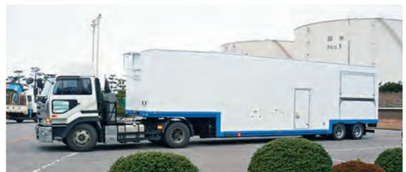
図20：エレベーターシャフト内アスベスト除去ロボット(左)と移動式アスベスト処理車(上)
