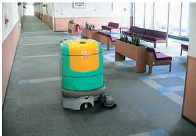
図1：オフィス内を移動する清掃ロボット
