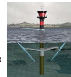
図 潮流発電の事例: SeaGenのシステム概念図(MCT社より)
