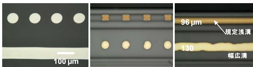
(a) IJ-Agパターン焼成(QW) (b) IJ-Agパターン焼成 (浅溝石英ファイバ)
