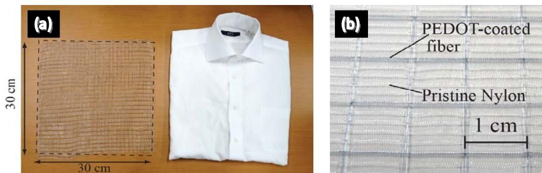
図③-(2)-3-2.7 (a)ウィービングにより作製したフレキシブルタッチセンサ (b)タッチセンサの拡大図
