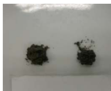
振動子に含まれるタングステンは超硬質でそのままでは精錬出来ないため酸化焙焼し、粉状となったものを酸に溶かし回収する。(写真左が焙焼前、右が後)
