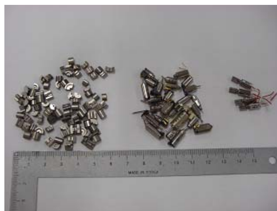
左写真の部品から取りだした振動子(左)、モーター(中)、全体(右)
