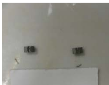
振動子に含まれるタングステンは超硬質でそのままでは精錬出来ないため酸化焙焼し、粉状となったものを酸に溶かし回収する。(写真左が焙焼前、右が後)
