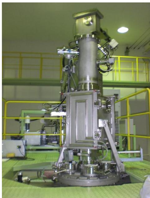
[溶湯サンプリング装置概観]
