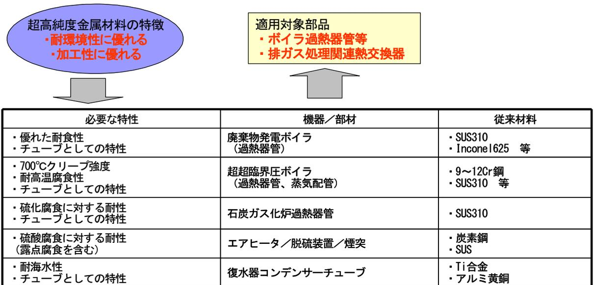
図 57 超高純度金属材料の発電プラントへの適用の考え方
