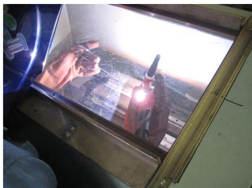
[バレストレイン試験片溶接用シールドボックス]
