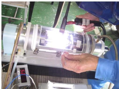
[丸棒突合せ溶接用シールドボックス]
