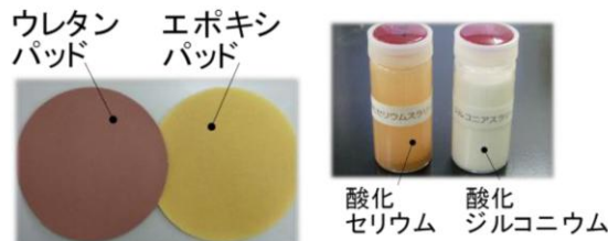
図 III-1-2 開発したエポキシ樹脂研磨パッドと代替砥粒
