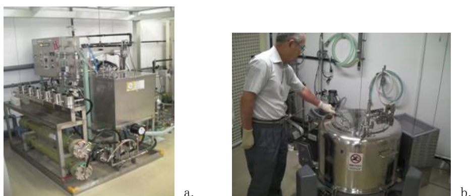
図14 膜利用精製プロセス ベンチスケール試験装置
