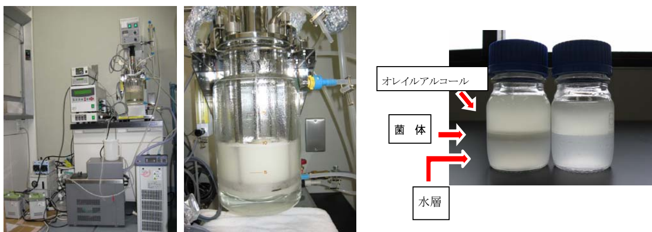
図－4 有機溶媒重層ジャーフェーマンターによる R. opacus B4 有機溶媒耐性株培養
