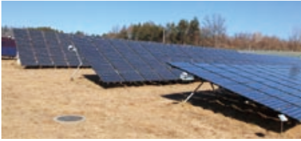
傾斜角特性の評価 (奥)45度、(中央)30度、(手前)15度
