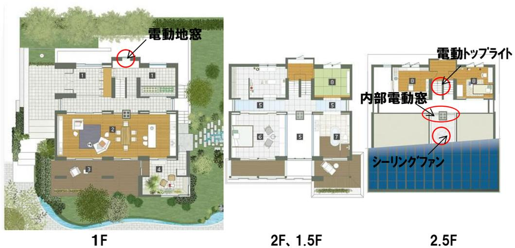
図 c-1-16 建物BのRT関連設備機器配置
