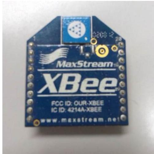
図 b-3-6 Digi 社 XBee モジュール
