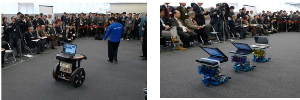
Fig. 57 先行デモンストレーションにおけるデモ風景 「人追従機能モジュール群」の動作風景(左) 「フォーメーションモジュール群」の動作風景(右)
