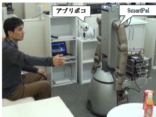
図 3.3.2.4.4-1 マルチモーダルインタフェースモジュールによる指差し認識
