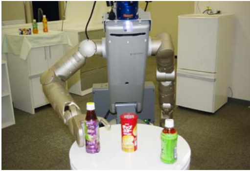
図 3.3.2.4.1-6 汎用モーション RTC による動作検証
