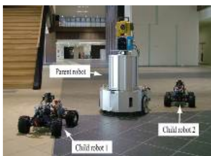
図 3.3.2.2.1-1 分散ロボットシステム
