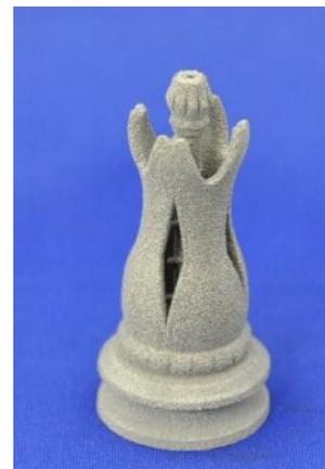
図Ⅲ-1.12 小型プラットフォーム試作機および成形例（チェスの駒）
