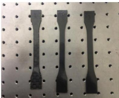
図 III-2.6.2 CFRP 切断検討
