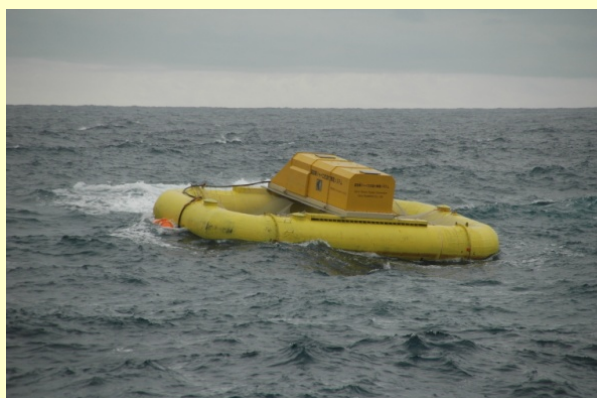
波力発電装置
