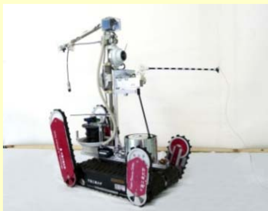
現場投入された「改良型Quince(クインス)」
