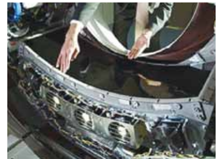
Aquilion ONE™のX線検出部 320列の検出器は断層撮影をするCTとしてはかなり幅があることが分かる
