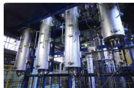
直径30cm、高さ2mの脱硫塔試験機
