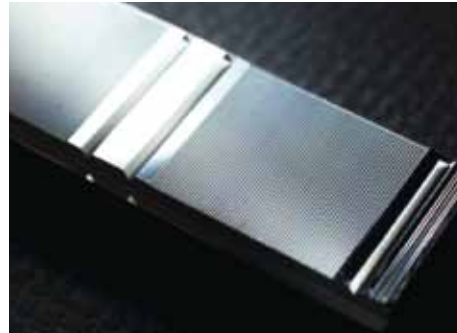
プロジェクトの成果として製作された、V60度-0.125mmピッチ金型
