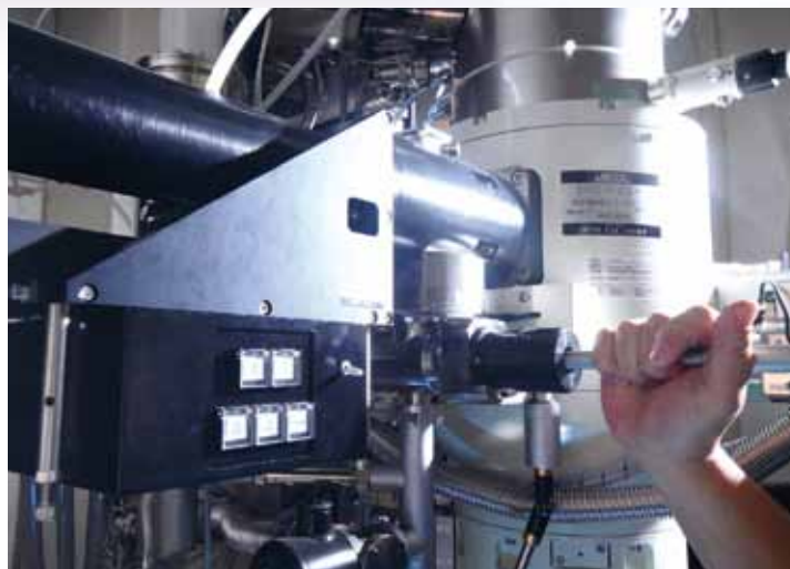
藤吉教授と日本電子が共同開発した最新世代の電子顕微鏡
