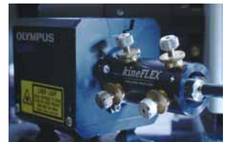
10cm弱の箱型にまで小型化されたレーザー発振器
