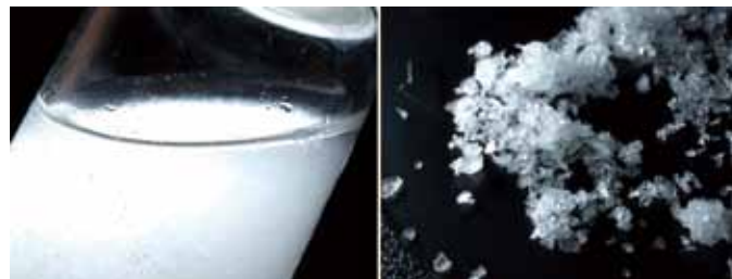
冷却後の水和物スラリ。水溶液が冷やされてスラリになると無色透明から白色に変わる
