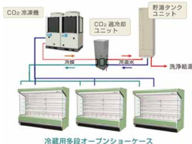
CO 2 冷凍機の過冷却廃熱を給湯利用する冷蔵ショーケースシステム
