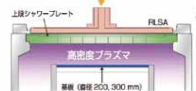
犬見教授らが開発したガスを均一化するチャンバーの構造模式図 [RLSA] は「ラジアルラインスロットアンテナ」の略、この装置の要となる技術
