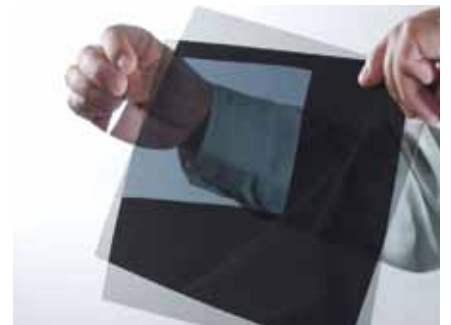
同一の光学特性を持つ光学フィルムを直交して重ね合わせると複屈折効果を打ち消し合せて着色が消える。この原理を利用して液晶ディスプレイでは色調やコントラストを保っている
