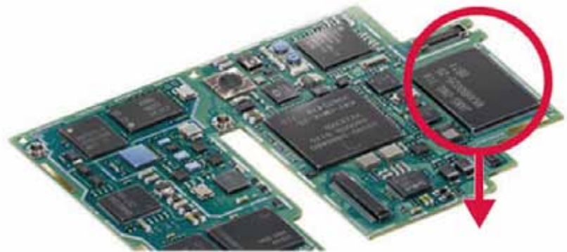
ダイボンディングフィルムを用いて貼り付けられた半導体チップ
