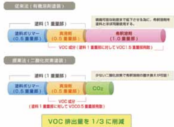
超臨界二酸化炭素塗装法によるVOC排出量の削減効果
