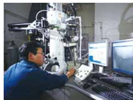
最新の極低温電子顕微鏡の自動試料交換装置
