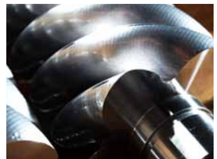
高精度加工されたスクリュー
