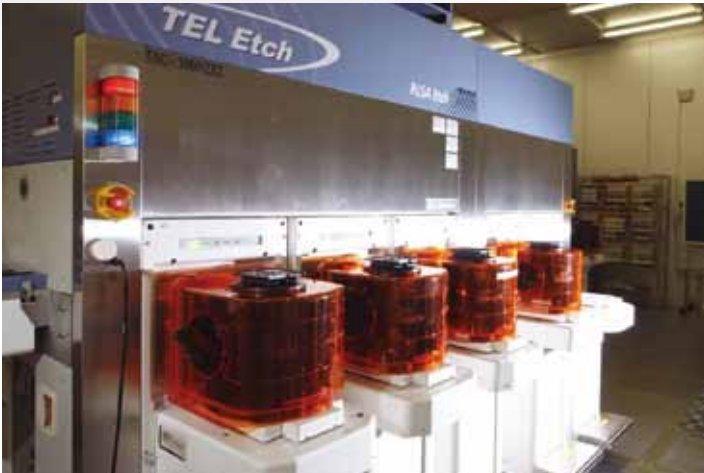
東京エレクトロンが開発・販売する、「マイクロ波励起高密度プラズマ技術を用いた半導体製造（エッチング）装置」
