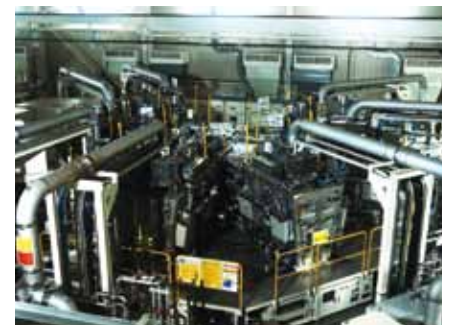
アモルファスシリコン太陽電池製造用のプラズマCVD装置星形なのは、直列でラインを長くしないためとラインの1工程がストップしても影響を最小限にするため。
