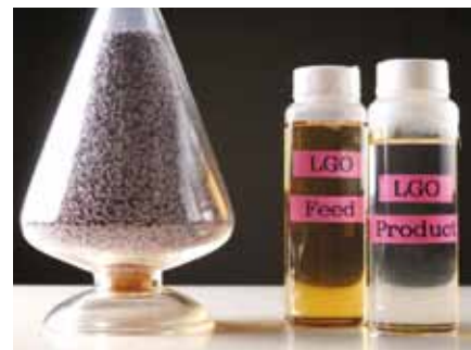
触媒「C-606A」(左)を用いるとクリーンな軽油が製造できる。
