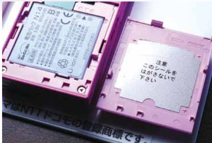
リカロイ™ [HMLXS シリーズ] RFID アンテナ感度補助用磁気シートとして、おサイフケータイやSuicaなどの誤作動を防止
