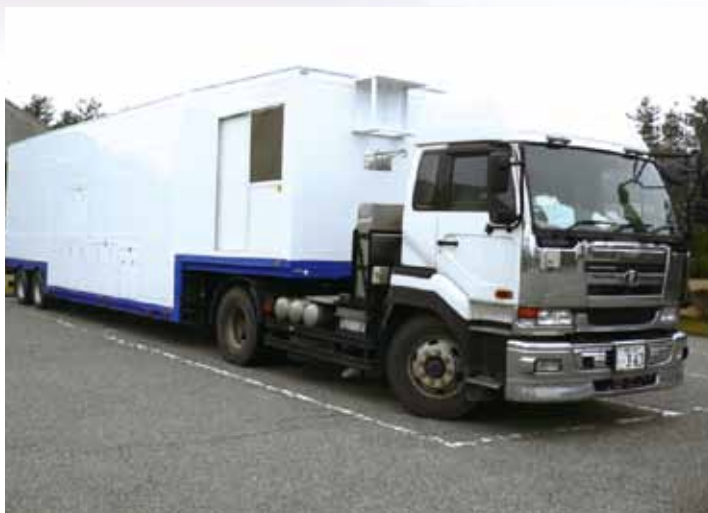
オンサイト式アスベスト溶融・無害化処理システム搭載トレーラー
