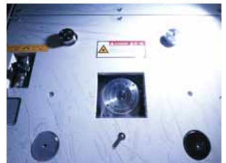
中央の円形部分から微細加工用のレーザが発振される
