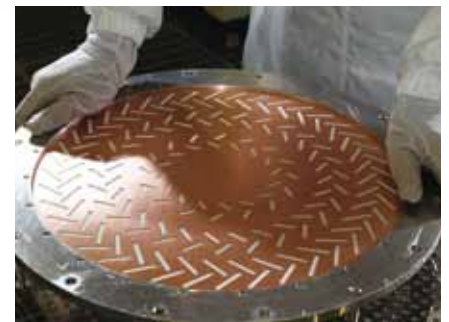
刻み込まれたスロットが特徴的な、ラジアルラインスロットアンテナ
