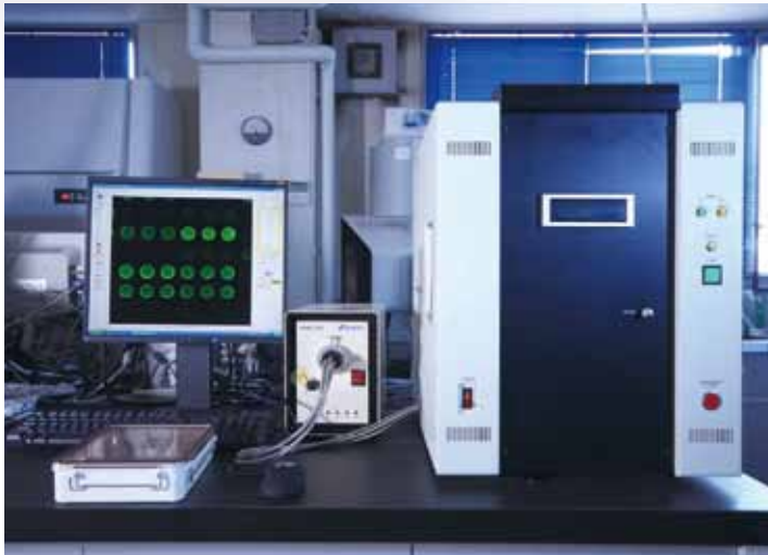
エバネッセント波蛍光励起法による糖鎖プロファイラー
