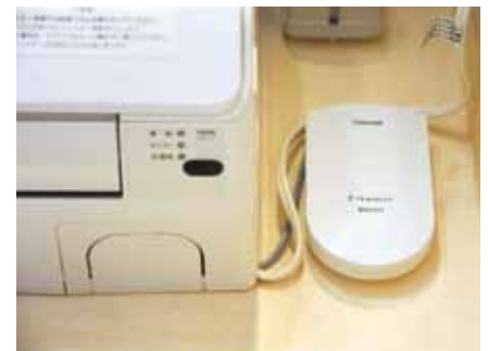
エアコン用Bluetooth接続アダプタ。Bluetoothはパソコンなどで利用される短距離無線通信技術。
