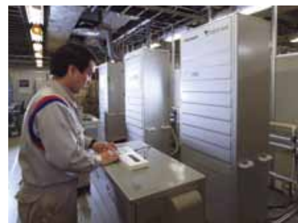
家庭で使われるために必要な4万時間の耐久性を担保するためのエネファームのシステム評価試験
