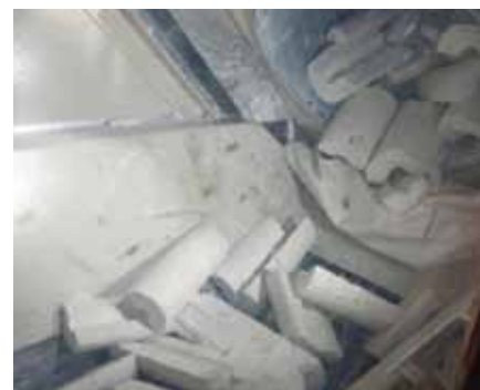
配管用保温材。中空構造で、袋詰め時にかさばる要因
