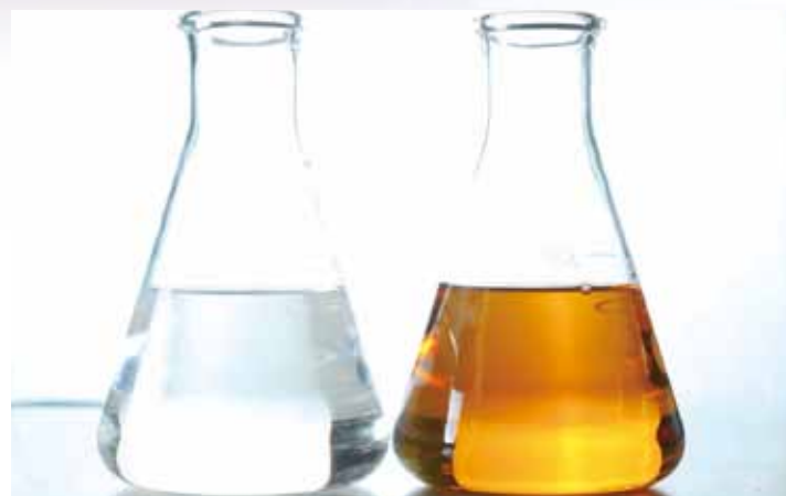
コスモ石油が開発した新規触媒により精製された「サルファーフリー」軽油（左）は、未精製の軽油（右）に比べて見た目にもきれいになっている。
