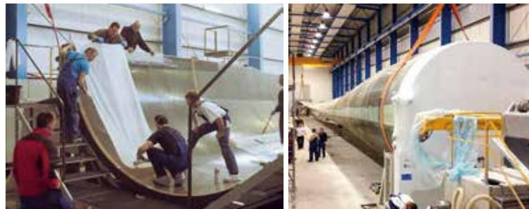
モールドと呼ばれるブレードを整形する型でブレードを製作します
