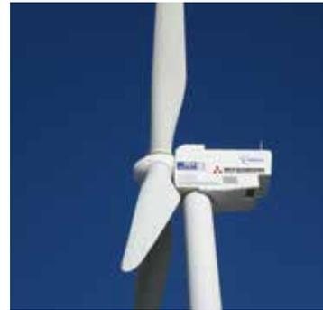
油圧DDTは工場内で試験した後に、実際に屋外で2.4MW級風車で発電試験を行います。
