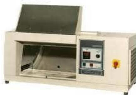
図Ⅲ-2-(ホ)-A-1(52) 光照射装置の一例：出光興産所有(キセノン光源)
