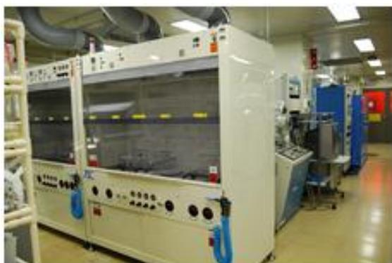
図Ⅲ-2-(イ)-A-1(1) 基板洗浄用ドラフト
