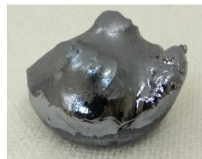
図III-2-(イ)-A-1(46) 融解・再凝固後の試料
