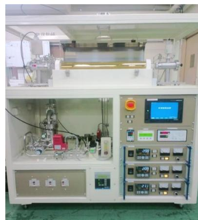
図 III-2-(ホ)-A-1(26) 結晶析出型昇華精製装置
