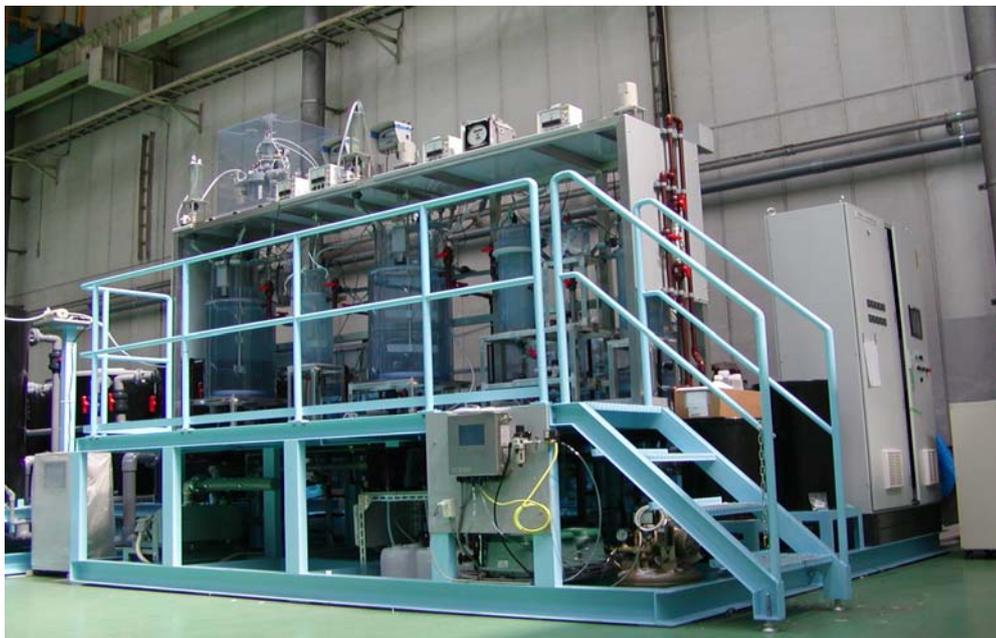
図 32 一体処理型排水処理設備
