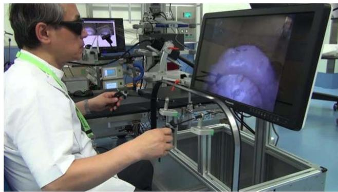
以下の機能・デバイスを統合した軟性単孔式 (SPS:Single Port Surgery) 手術支援装置を開発し、実用化を目指す。
