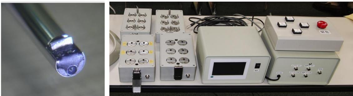
5. **共通コンソール** … 脳神経外科サブプロと消化器外科サブプロにて共同で開発を行なった。用手的な手技における手の動き、ツールの種類、ツールの持ち方が大きく異なるため、最終開発物は大きく異なる構成をとるが、通信プロトコルは両者共通であり、基本的な互換性がある(スレーブ側の可動域が異なる、ボタンに割り付けた動作が異なるなど差異があるため完全互換ではない)。その元となったのは、胸部外科サブプロで試作したハプティックデバイス利用の簡易コンソールである。
