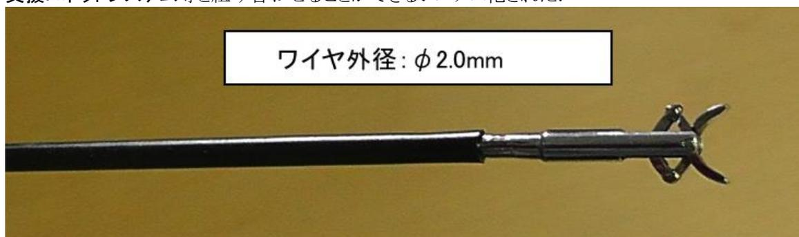
2. FBG 技術 … 脳神経外科サブプロにて FBG 技術による鉗子の多点力計測の技術を開発して、胸部外科サブプロに提供した。
