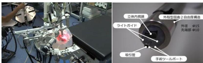
図 10 手術ロボット機構
