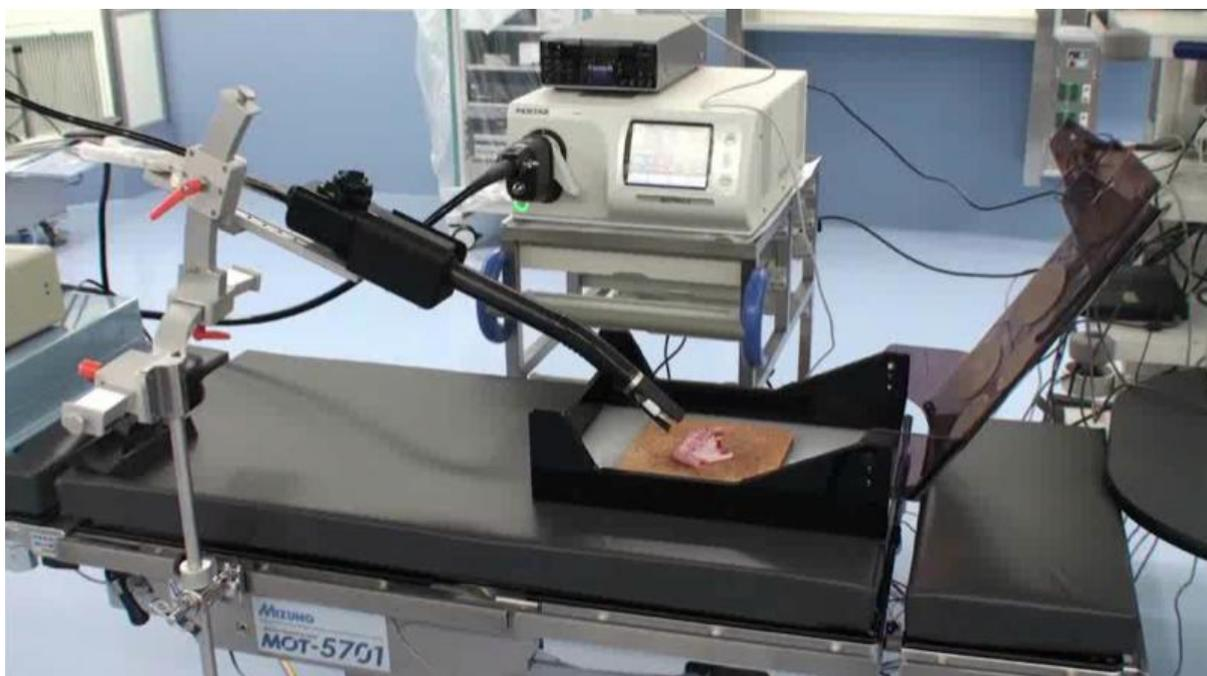
図3 軟性単孔式(SPS)手術支援装置の外観
