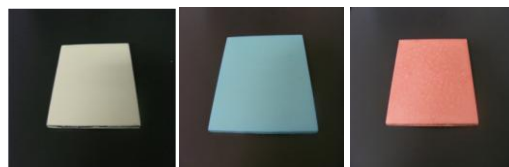
図Ⅲ-2-④-15 スプレーコートで得られたコーティング膜。基材：セラミックス板。膜厚 200 μm
