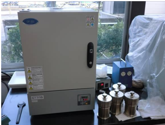
図Ⅲ-2-②-12 水熱処理で使用した高圧用反応分解容器 (100mL×4 個、右下) と、強制対流式乾燥器 (左)
