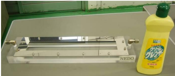
図Ⅲ-2-②-4 流通式光触媒活性評価用アクリルチャンバー
