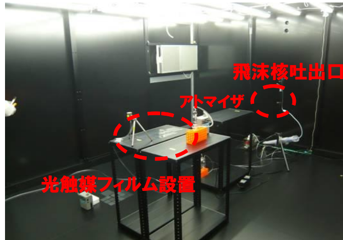
図Ⅲ-2-③-27 小空間における飛沫核散布実験
