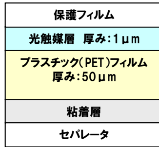
図Ⅲ-2-③-18 可視光型光触媒フィルム材の構造
