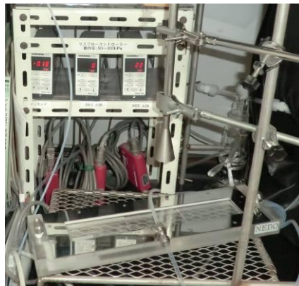
図Ⅲ-2-②-6 マスフローコントローラーと流通型アクリルチャンバーを組み合わせた、流通型評価装置
