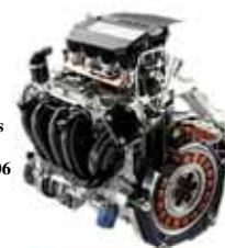
3ステージVTEC-iMA ハイブリッド自動車用モーター http://www.honda.co.jp/tech/auto/engine/honda-ima/detail/index.html
