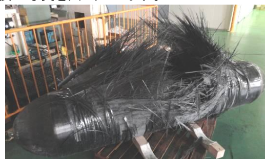
図4 破裂試験後の試作 200L 蓄圧器
