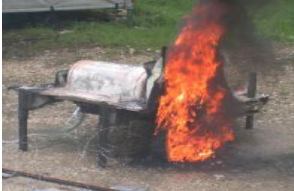
図4 車載容器(ホワイトボディ車)の局所火炎暴露試験のイメージ
