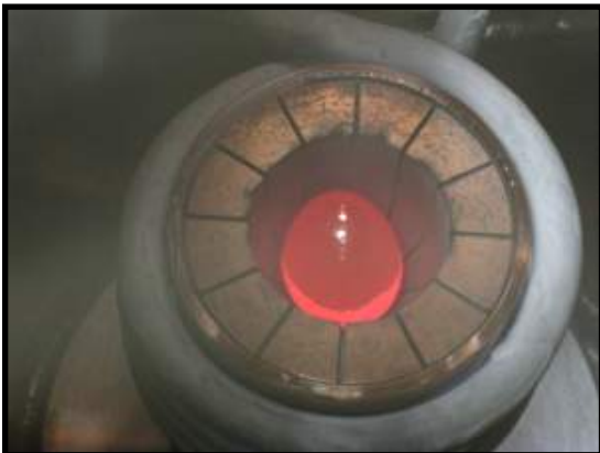
図 7. 浮遊溶解中の CaLi 2 系合金の様子
