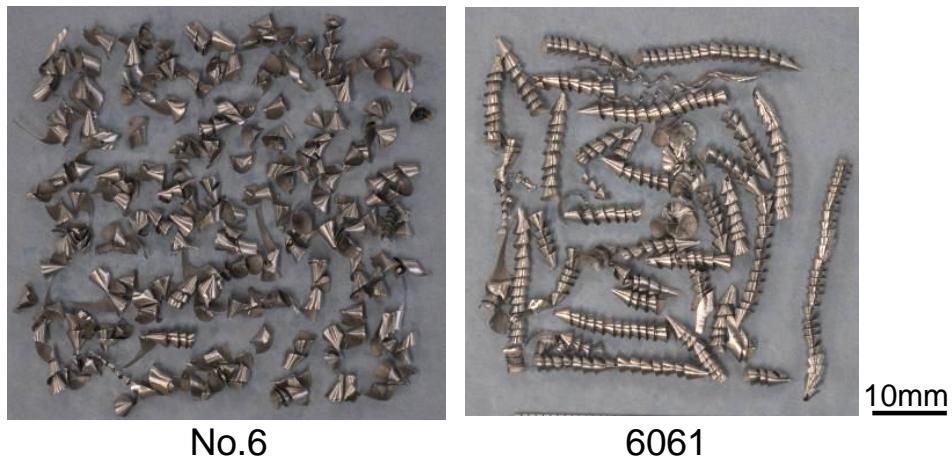
図9 ドリル穴明け加工後の切粉外観写真（同重量で比較）
