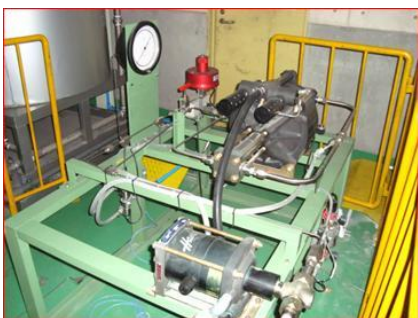
図14 破裂試験用高圧ポンプ
