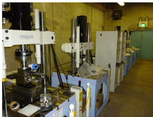
図6 新規導入高圧水素中小型疲労試験装置および機械試験機
