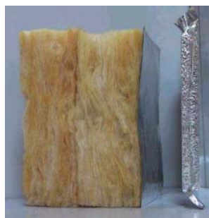
図表 6-1 同じ熱抵抗の繊維系断熱材 (左) と真空断熱材 (右)
