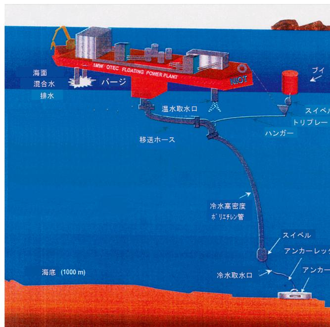
図 6-62 1MW 海洋温度差発電の概念図
