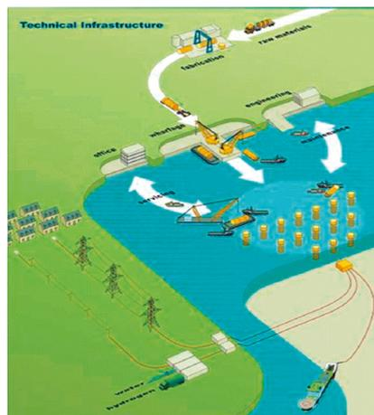
図 6-65 海洋エネルギー発電を 1GW 導入に必要なインフラ施設/設備（一部抜粋）
