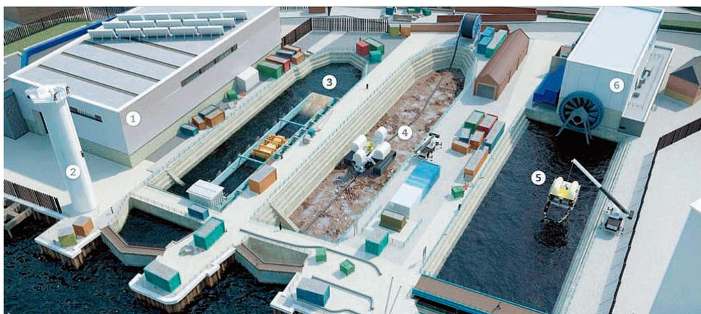
① 実験棟 ② 風力タービン試験設備 ③ 波動水槽 ④ 模擬海底
