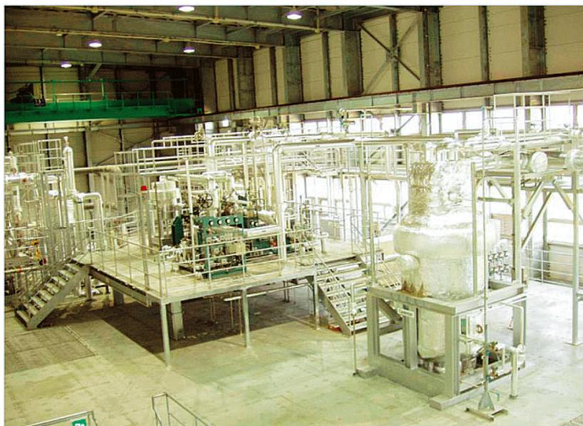
佐賀大学海洋エネルギー研究センターには、30 kW 海洋温度差発電装置が設置されている。最近の研究成果では、濃度 99 % 以上のアンモニアと水の混合液による作動流体を用いた場合に、温度差 21 °C、温水流量 111 kg/s、冷水流量 111 kg/s で最大正味出力約 20 kW を得ている。また、温海水および冷海水を模擬した海水淡水化実験装置でも効率よく淡水化できることを実証している。
