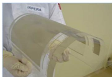
試作した全印刷製造TFTシート
