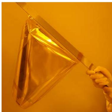
図Ⅲ-2.3.3-1 全印刷フレキシブル TFT アレイ
