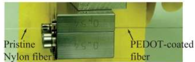
図③-(2)-3-2.2 (a)ダイコーティング装置の外観、(b)ダイスの模式図
