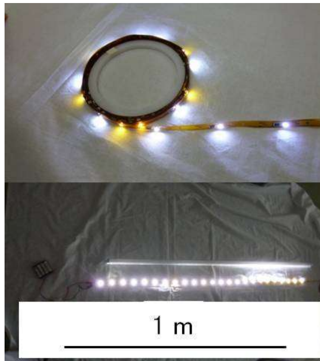
図③-(2)-3-2.17 フレキシブルプリント基板へ実装された LED 基板とその発光の様子
