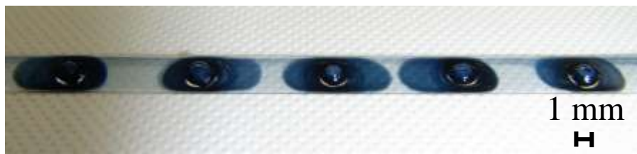
図③-(2)-3-1.13 リールツーリールシステムを用いて幅 5mm の長尺 PET リボン基材に連続的に形成した PEDOT:PSS 被覆エラストマー接点構造。
