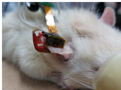
図 -(2A)-1.32 装着された蛍光検出装置
