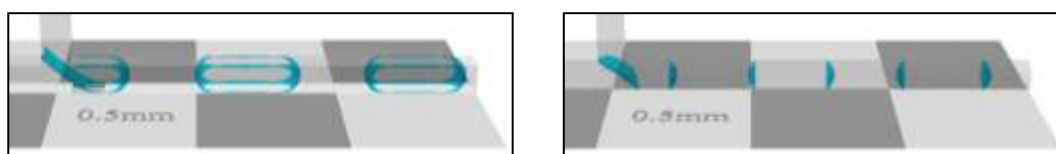
図③-(2)-2-3.16 矩形および円形断面 T 型流路の計算結果
