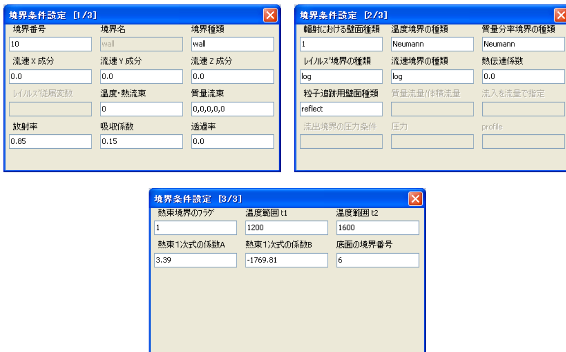
図III-2-①-3-92 燃焼解析の境界条件設定パネル
