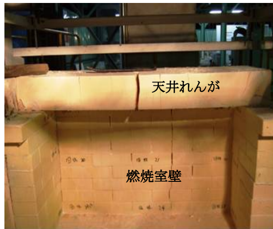
図Ⅲ-2-①-1-52 使用後の試験炉燃焼室内部
