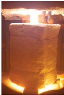
気中溶解の様子(RFプラズマ加熱)
