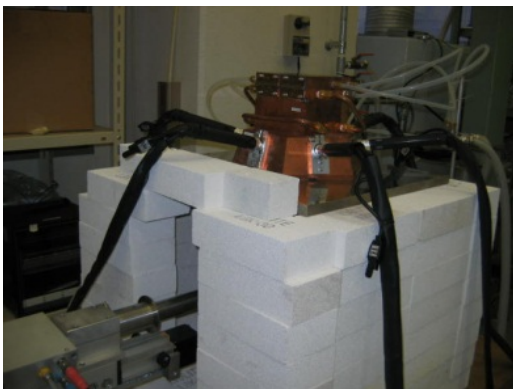
図Ⅲ-2-①-2-1 6相交流アーク発生装置の写真。
