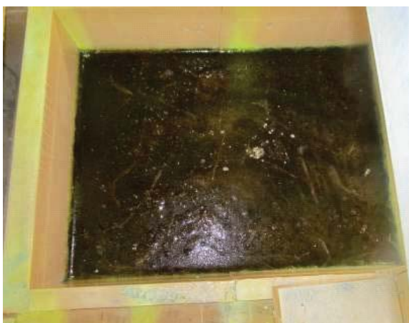
熔融したアンバーガラス(冷却後)
