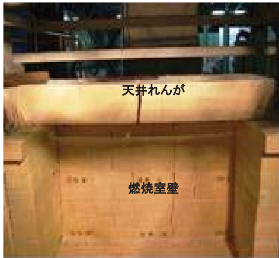
使用後の試験炉燃焼室内部
