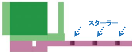
東洋ガラス試験炉のフィーダーに配置したスターラー
