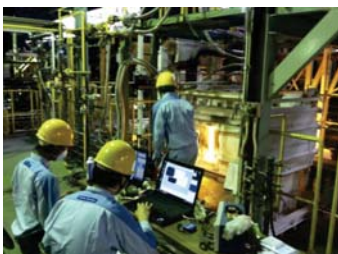
東洋ガラス川崎工場気中溶融炉における観測実験
