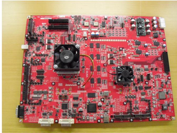
図 3.2- 9 SMYLEvideo の実装検証ボード
