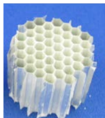
泳動電着法で作製したTMPS担持ハニカム
