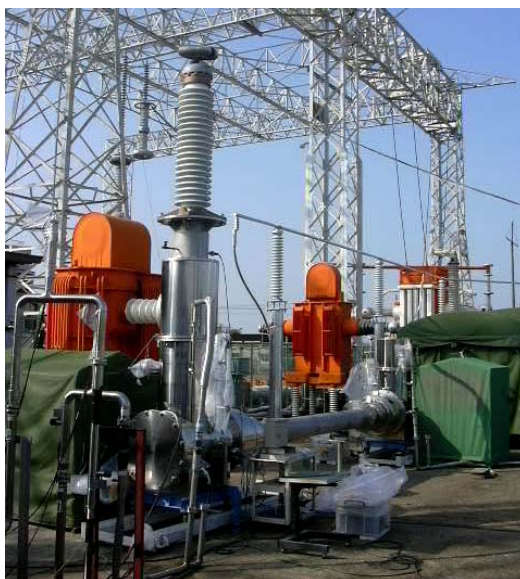
図 2.1.3-13 課電試験システム外観
