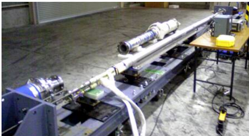
図 2.1.5-7 三心コア圧縮試験装置の概観写真
