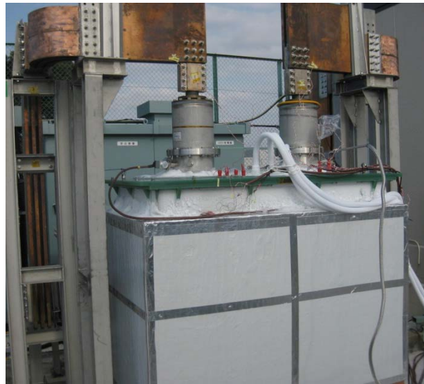
図 2.5.2-5 12 kA 通電時の試験外観
