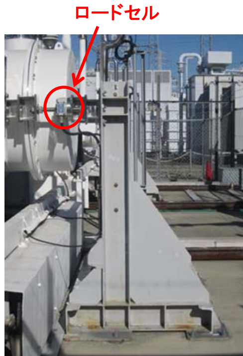
図 2.4.3-3 端末荷重測定用ロードセル
