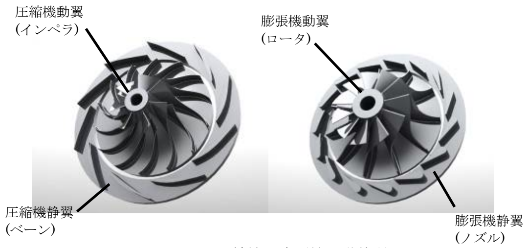
図 2.6.3-1 圧縮機・膨張機の動静翼
