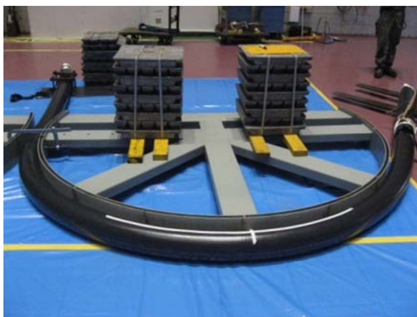
図 2.4.2-12 曲げ試験状況
