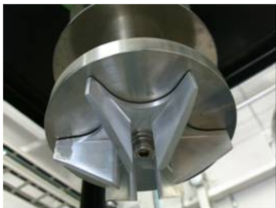
(a) ポンプ A 羽根状況
