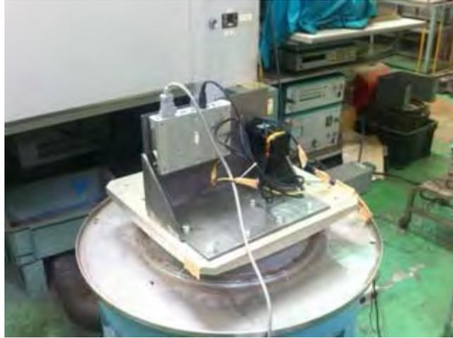
図 5.3.5-3 レーザースキャナの振動試験
