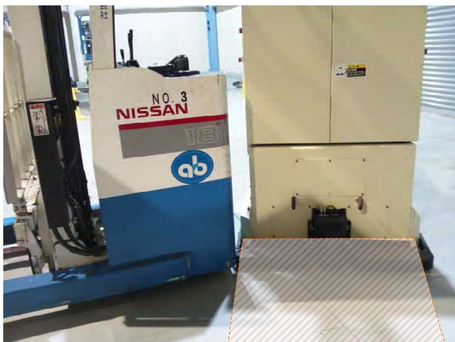
図 4-5 AGV とフォークリフトとの接触 (AGV 前方方向)
