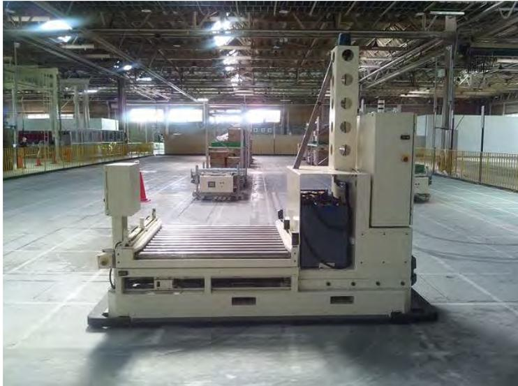
図 3-2 コンベヤタイプ AGV
