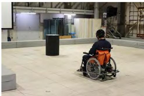
図 4.5.2-7 障害物（円筒 黒φ600）の試験の様子
