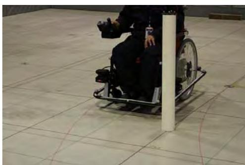
図 4.5.2-8 障害物（円筒 白φ100）の試験の様子
