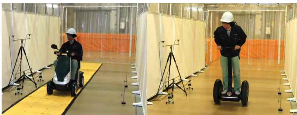
図 4.2.2.4 模擬ロボットによる騒音試験の様子
