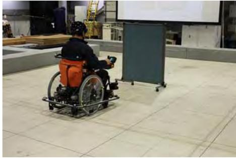
図 4.5.2-9 障害物（壁 青布）の試験の様子
