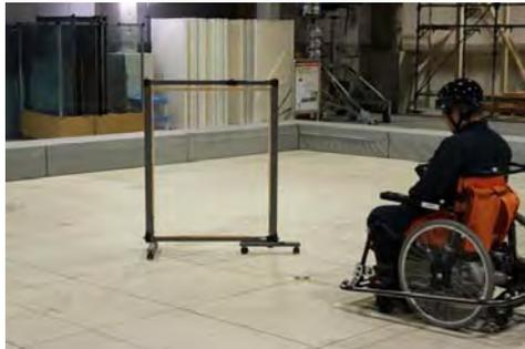
図 4.5.2-10 障害物（壁 透明プラスチック）の試験の様子
