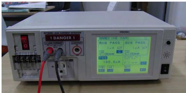
図 4.2.1.2 漏れ電流試験器 (ST5540)
