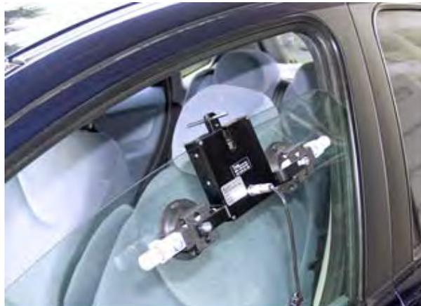
図4.2.5-4 パワーウィンドウの挟圧安全性試験の例
