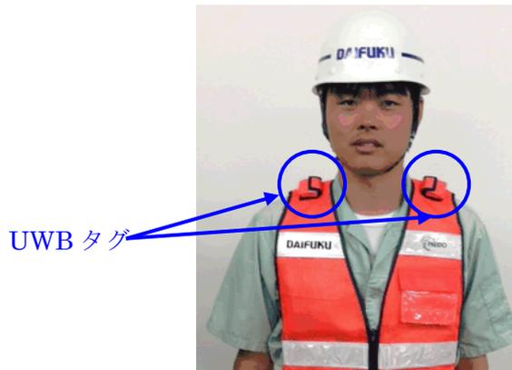
図 4-2 作業者への UWB タグの取り付け
