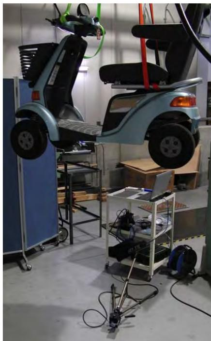
図 4.2.3.2 電動車いす底面の温度測定の様子
