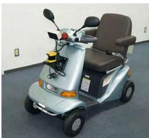
図表 6-4 段差検知センサを搭載したハンドル型電動車いす
