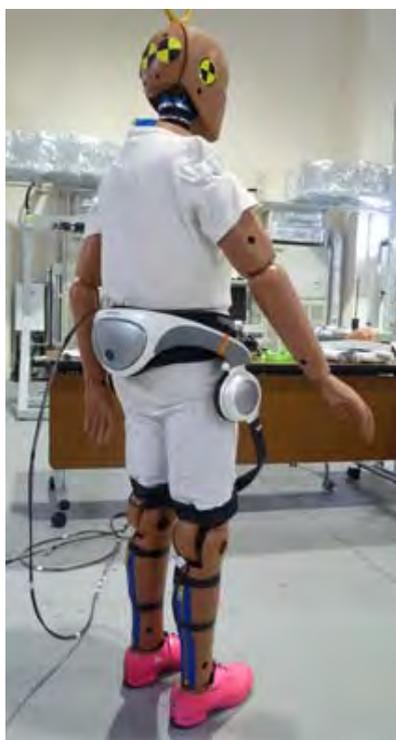
Figure 2.2-1 歩行アシストを装着した衝突実験用ダミー人形
