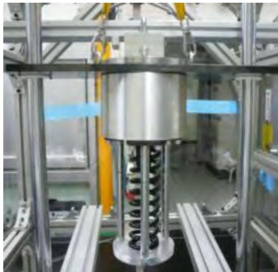
Figure 2.2-4 落下試験装置の錘部分
