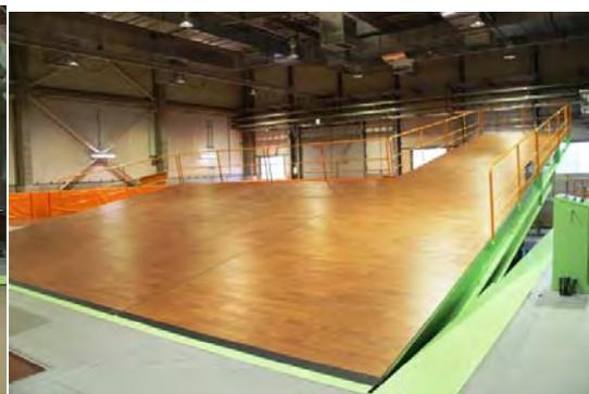
(b) 傾斜路走行試験設備
