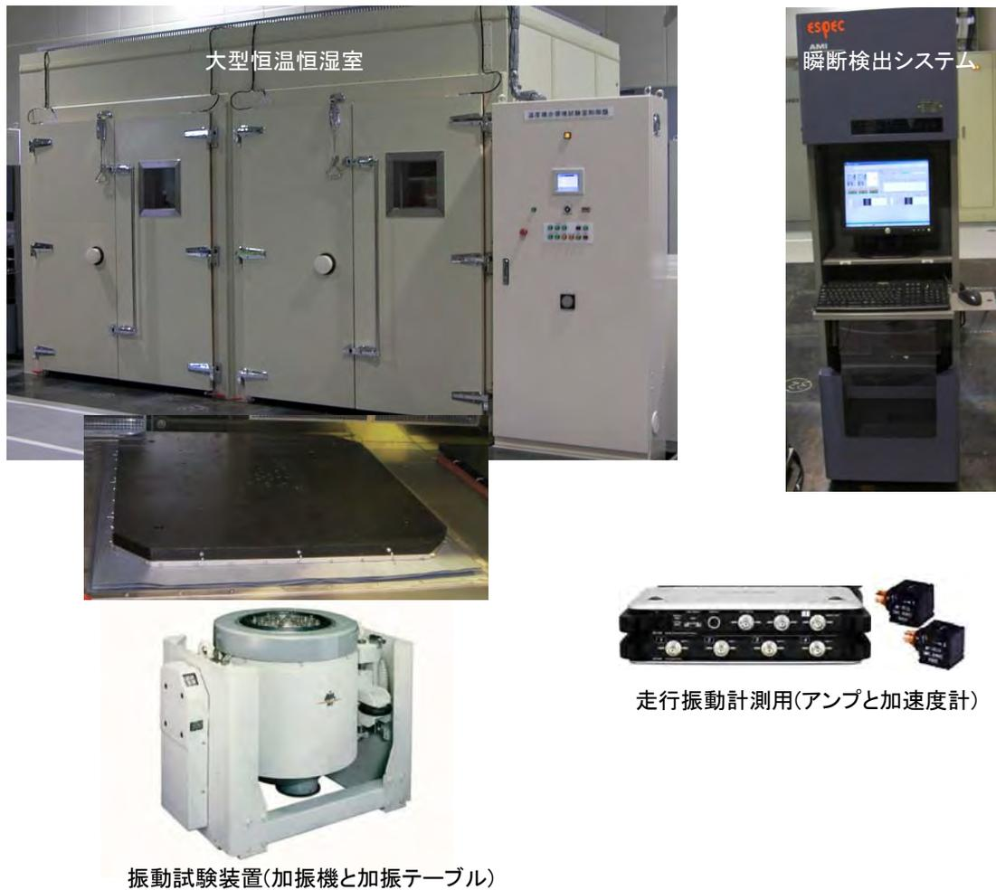
図 4. 3. 1. 1 複合環境試験設備の構成装置
