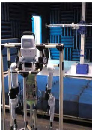
図 3 EMC 試験の様子
