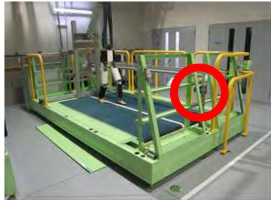
図 4.3.2-7 ベルト式走行耐久性試験装置
