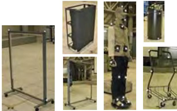
図 4.5.2-3 各種障害物（壁，円筒，人体ダミー）の例
