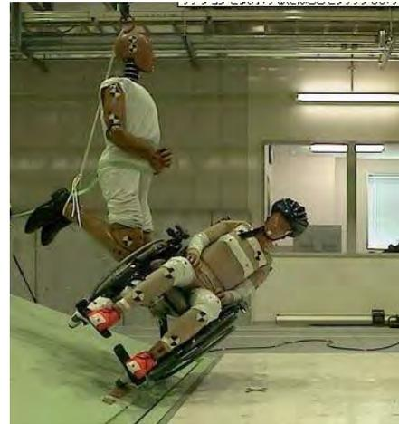
図4. 6. 4 ダミーによる車いすの転倒試験
