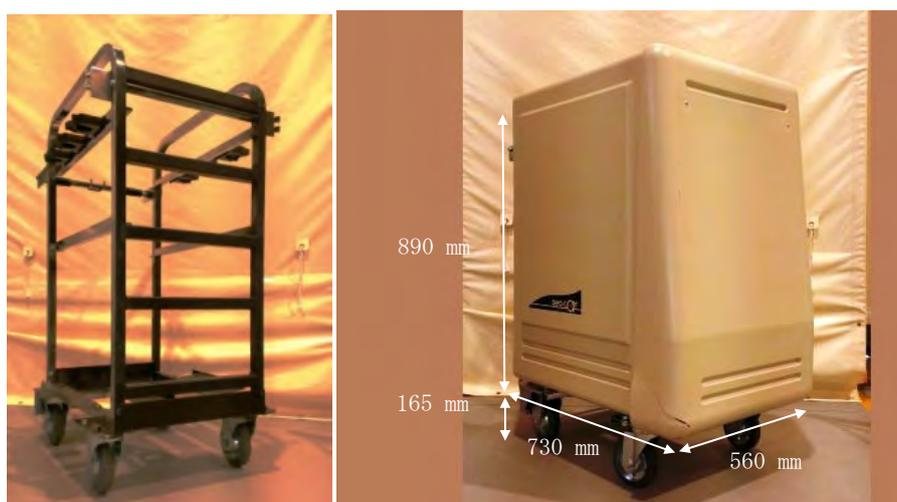
図 4.2.4.4-1 移動作業型ロボットを模した移動体
