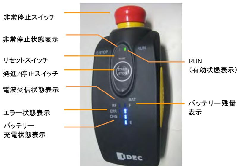
図表 2-14 安全無線非常停止装置のリモコン側の外観
