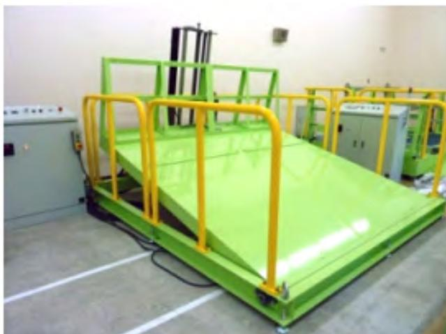
図 4.1.1-1 静的安定性試験装置
