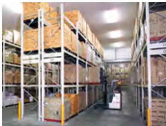
図 1-1 平置、パレットラック、フォークリフトの例
