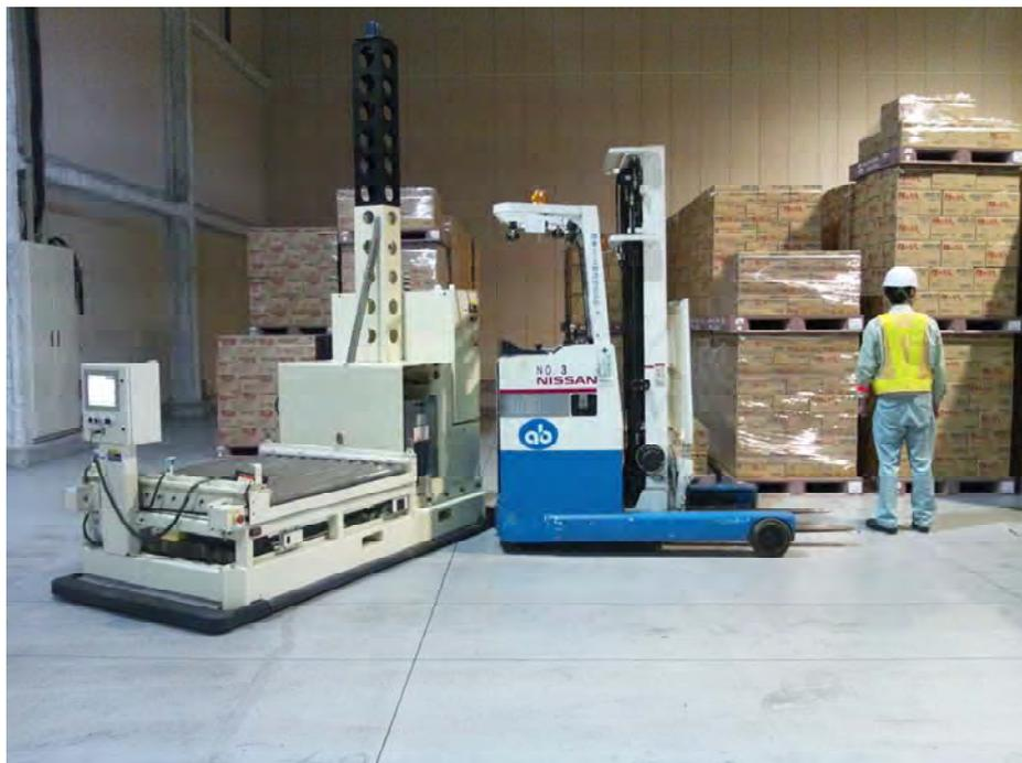
図 4-4 AGV とフォークリフトとの接触
