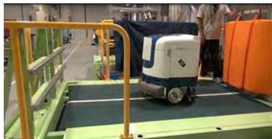
図 4.3.2-8 位置制御装置の応答特性試験
