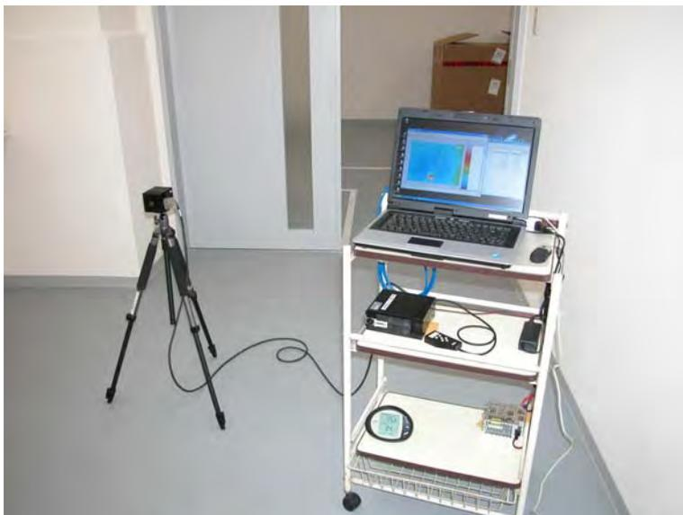
図 4.2.3.1 FSV-1100 と専用ソフトウェアをインストールしたノート PC の接続状態
