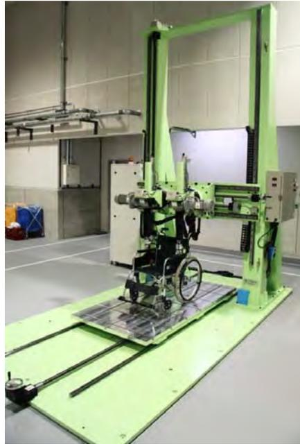
図 4.3.3-1 耐荷重試験装置
