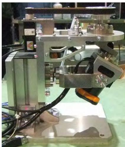
図 5.3.8-10 1リンク揺動機構 機構部
