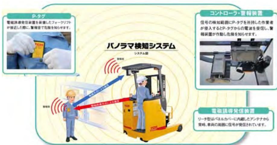
図 5.6.4-1 ユニキャリア製接近警報装置
