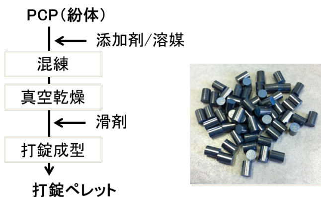
図Ⅲ.2.1.3-7 打錠成形のフローと得られたペレット
