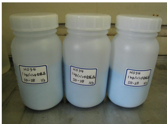
図Ⅲ.2.1.3-6 1kg/バッチ合成したSD-28(左)およびその吸着挙動(右)
