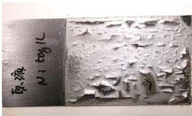
図Ⅲ2. 6. 2. 2-20 未処理電解液の電解析出物
