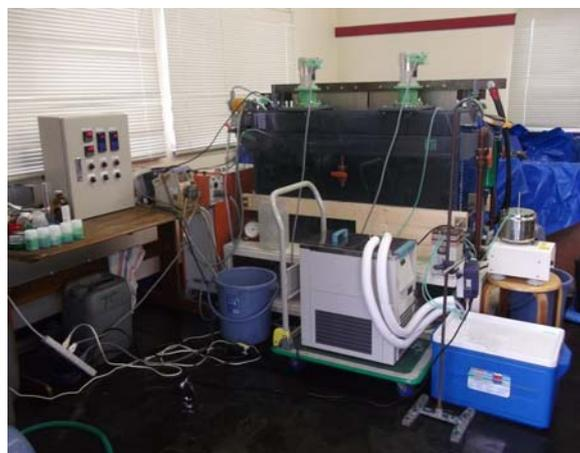
図Ⅱ.2.1.6.2-11 晶析法による電解液中の硫酸ソーダ除去実験（中央下：チラー、
