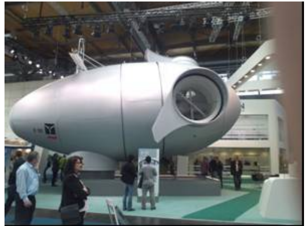
図Ⅲ. 2. 7-12 ENERCON 社のナセル (穴の部分に 50m のブレードが付く)
