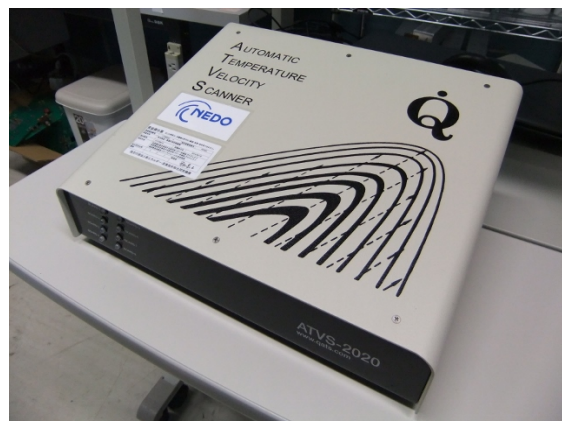
図Ⅲ.2.5.6-200 風速風温測定機
