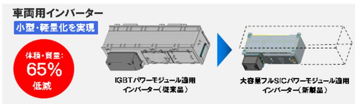
図Ⅲ.2.4.2-39 従来インバータ装置との体制・重量比較
