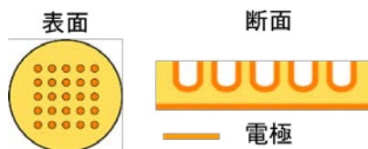
図Ⅲ. 2. 5. 1-47 本研究で開発した評価法の電極構造
