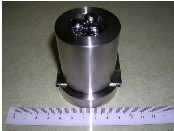
図Ⅲ.2.5.3-12 ボール・オン・3 ボール試験治具
