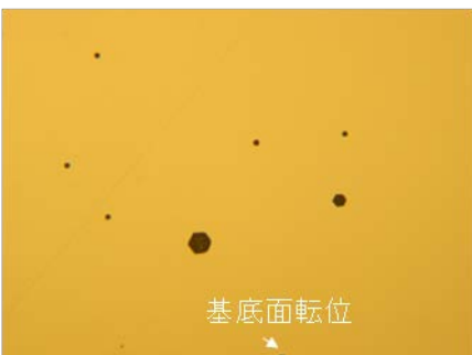
図Ⅲ.2.1.1.1-23 5 点の測定点の模式図とエッチピット写真
