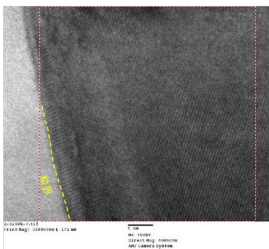
図Ⅲ.2.5.1-8 図Ⅲ.2.5.1-7○部分の拡大画像（格子像）（111 入射）
