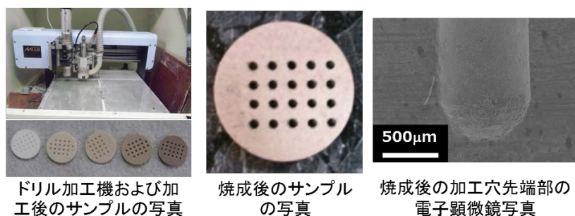
図Ⅲ. 2. 5. 1-48 ドリル加工に使用した装置および加工後のサンプルの写真、 焼成後のサンプルの写真、焼成後のドリルホール断面電子顕微鏡写真
