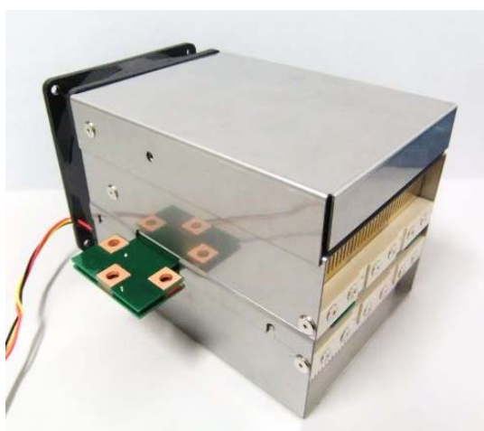
(a)インバータユニットの外観
