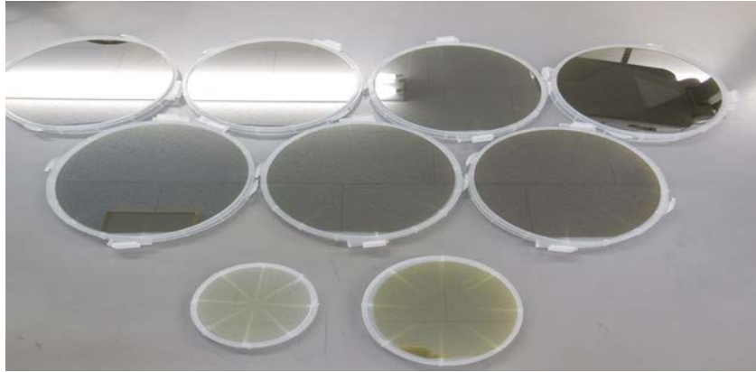
図Ⅲ.2.1.1.1-27 彦根出張所で製造した高品質 6 インチ 4H-SiC ウエハ写真 (写真手前は 3 インチウエハと 4 インチウエハ)
