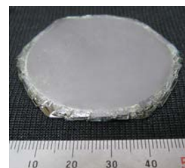
図Ⅲ.2.1.2.2-3 育成した 4H-SiC 単結晶(口径 2" × 3.4mm)
