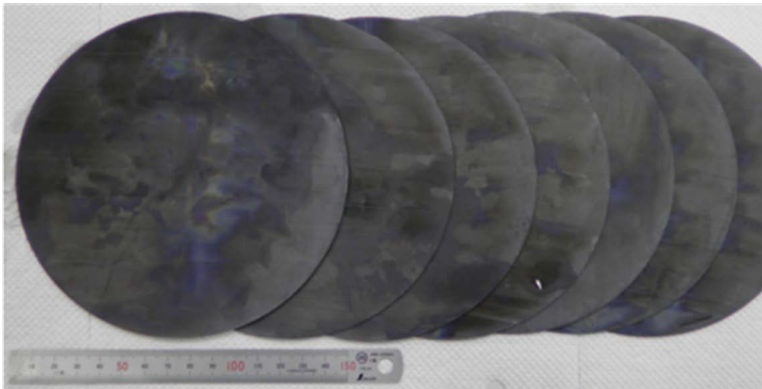
図Ⅲ. 2. 2-25 マルチワイヤー放電加工による 6 インチ切断ウェハ
