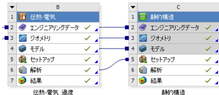
図Ⅲ.2.5.4-24 ANSYS による電気-伝熱解析と構造解析の設定
