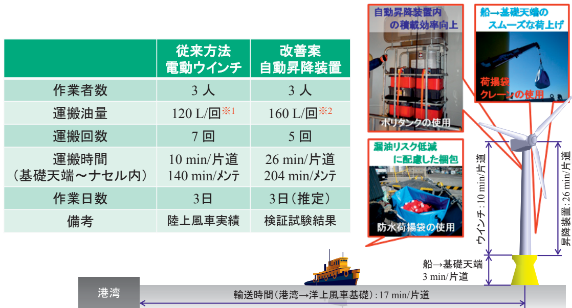
図 3.8.3-14 増速機の潤滑油交換時間短縮対策(東京電力・鹿島建設資料)
