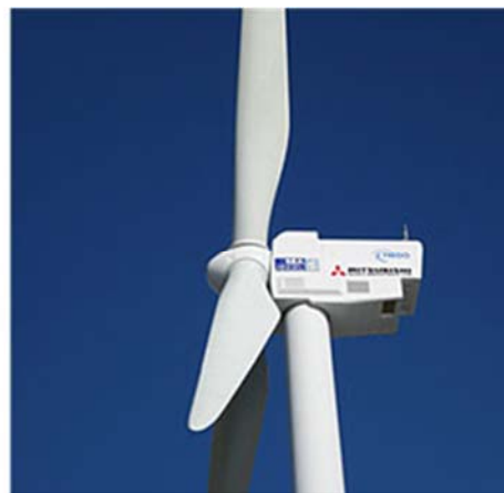
図-3 SEA ANGEL 三菱重工業 7.0MW (油圧ドライブ+同期式発電機 : NEDO HP)
